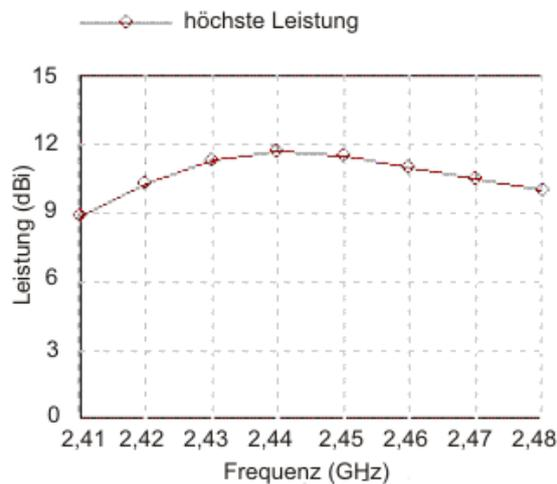
Mit einer Kupferplatte oder einer Aluminiumplatte als Reflektor ist die elektrische Leitfähigkeit sogar noch besser und damit die Gesamtleistung der Antenne höher. Man erreicht auf diese Weise einen Antennengewinn von bis zu 12 dBi.
