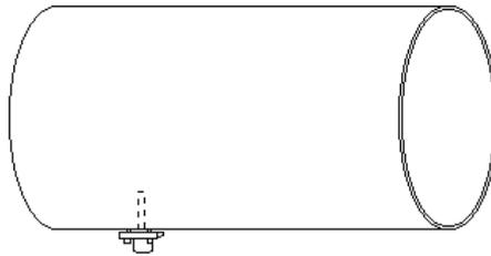
Setzt man vor diese Dose noch einen Trichter, kann man einen Antennengewinn von ca. 14 dBi erreichen. Allerdings muss sie genau ausgerichtet werden.
